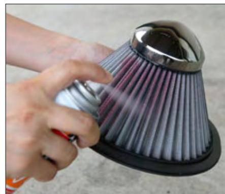
6. フィルターが乾きましたら、フィルターのひだに沿って外側より軽くフィルターオイルをスプレーし、5分程度放置します。
