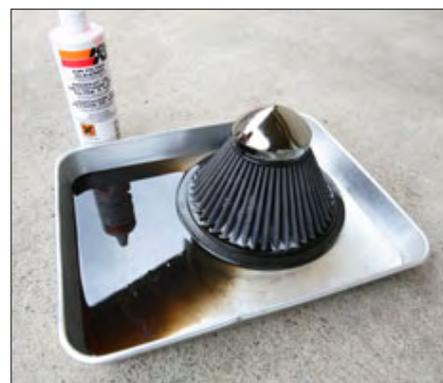
3. 30分程度放置します。(汚れの度合によって時間は調整して下さい。)
