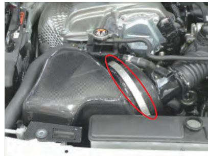
14. Vクランプを使用して、カーボンドクトケースとエアフィルター、カーボンエアフローアダプターを固定します。
