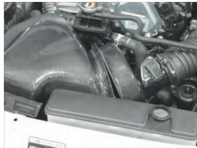
13. カーボンエアフローアダプターを純正エアースホースに挿入します。
