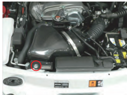
16. カーボンドクトケースを純正スクリューで固定します。
