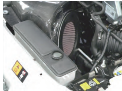
11. カーボンドクトケースをフレッシュエアダクトに挿入しながら車両に配置し、エアフィルターを仮付けします。
