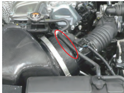
15. サブタンクホースの図示部にコルゲートチューブを被せ保護します。次に、エアフローセンサーのカプラーを接続します。
