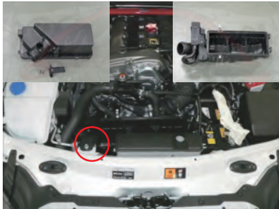
2. エアークリーナーカバーとエアークリーナーエレメントを取外し、エアフローセンサーを取外します。次に、○印部のスクリューを取外し、エアークリーナーケースを取外します。
