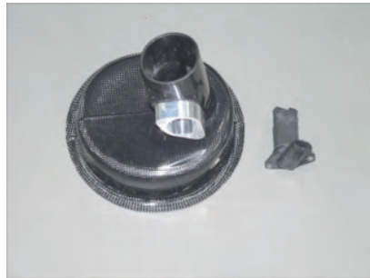
12. ビスBを使用して、カーボンエアフローアダプターにエアフローセンサーを取付けます。
