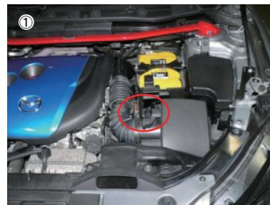
エアーフローセンサーのコネクターを切離し、エアーホースのホースクランプを緩めます。
