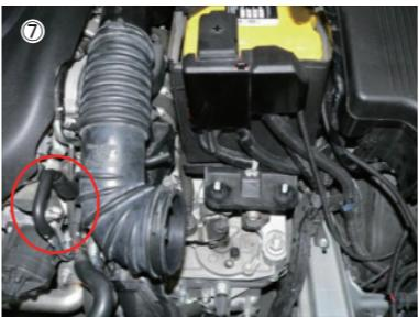
エアクリーナーカバーに接続していた図示のφ6ホースを車両から取外します。
