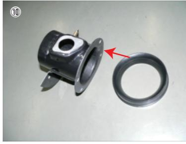
アダプターをセンサーパイプにビスCで固定します。
