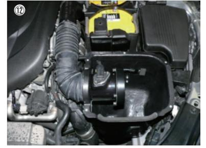
センサーパイプを純正エアーホースに接続し、ホースクランプで固定します。
