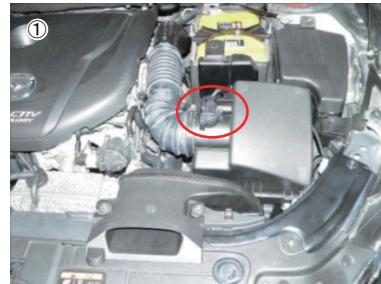
エアフローセンサーのコネクターを切離し、エアーホースのホースクランプを緩めます。
