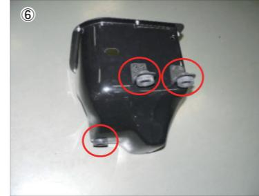
樹脂ステーに純正マウンティングラバーを取り付け後、ロアケースにビスBで取付けます。
