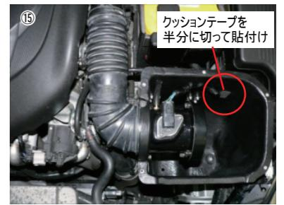
エアフローセンサーharnesを通した穴の隙間にクッションテープを貼付けます。
