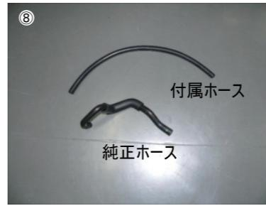
純正φ6ホースを取外し、付属ホースと交換して取付けます。
