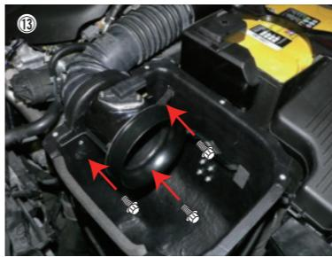
センサーパイプをロアケースにビスC、ナットで固定します。
