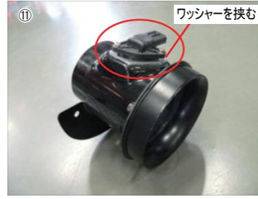
センサーパイプにワッシャーを挟み、エアフローセンサーをビスAで固定します。
