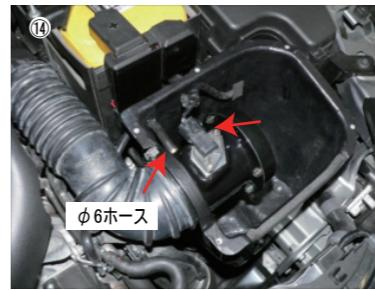
φ6ホースをセンサーパイプに接続します。エアフローセンサーharnesをエアフローセンサーに接続します。
