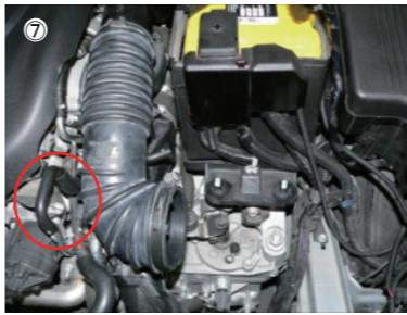
エアクリーナーカバーに接続していた図示のφ6ホースを車両から取外します。
