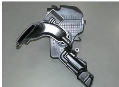
4. フレッシュエアダクトを固定しているクリップを2箇所外します。爪をおこし回転させてフレッシュエアガイドを取外します。
