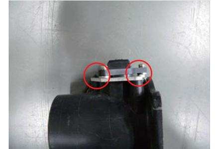
9. エアフローアダプターにワッシャーx2を挟みビスCx2でエアフローセンサーを取付けます。
