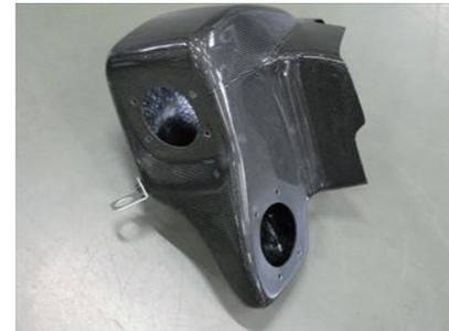
11. カーボンケースにビス Bx1 を使用してステータを取付けます。ステアの向きは写真を参考にしてください。
