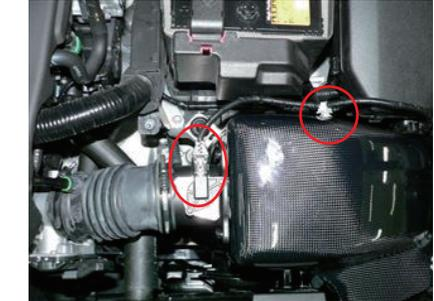
18. エアフローセンサーコネクタとエアフローセンサーの配線留めを取付けます。各部増し締めを行い作業完了です。
