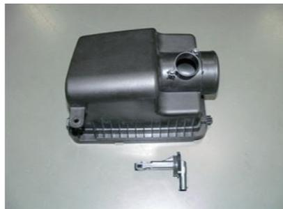
6. エアクリナーカバーからエアフローセンサーを取外します。
