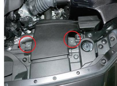
17. フレッシュエアダクトのゴムスペーサーを取り付けた場所をジョイントアダプターに刺し込む様に配置します。純正ボルトでフレッシュエアダクトを固定します。
