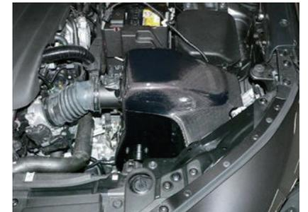
15. カーボンケースを車両に取り付けます。エアホースをエアフローアダプターに刺し、バンドを締め付けます。ゴムブッシュが奥まで刺さっていることを確認してください。
