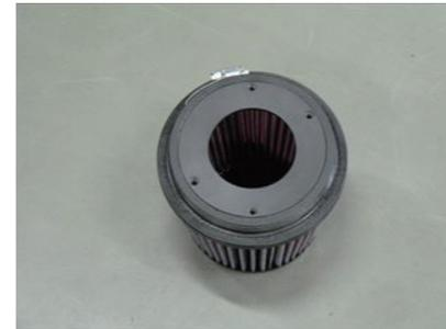
10. ファンネルアダプターにエアフィルターを取付けバンドで締め付けます。
