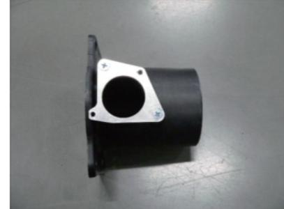
8. ビスDx2を使用して、エアフローアダプターに変換プレートを取付けます。
