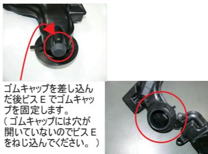
ゴムキャップを差し込んだ後ビス E でゴムキャップを固定します。(ゴムキャップには穴が開いていないのでビス E をねじ込んでください。)
