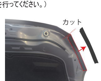
18. 図を参考に、ヘッドライト上部付近のボンネット裏のウェーストリップを切除して、作業完了です。
