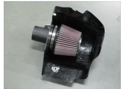
9. エアフィルターを取付けます。
