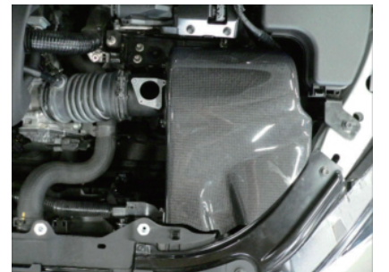
12. カーボンケースASSYを車両に配置します。
