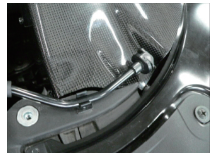
15. ボンネットロックステーを一旦戻し、カーボンケースと干渉しないかを確認します。 (干渉する場合はスTEEを緩めて取付け位置の微調整を行ってください。)
