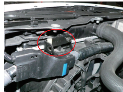
11. スペーサーを挟みビスDでスTEE-Bを取付けます。
