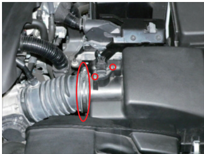
2. エアフローセンサー固定ビスを取外し、コネクターを接続したままエアフローセンサーを取外し、エアホースのホースクランプを緩めます。
