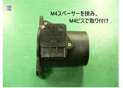
ノーマルケースからエアフロセンサーを外し、エアフロアダプターに取り付けます。
