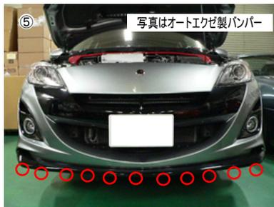
導入プレートを取り付ける為、バンパーを外します。下側のタッピング、ボルトを外します。(純正バンパー車も同様に取外してください。)
