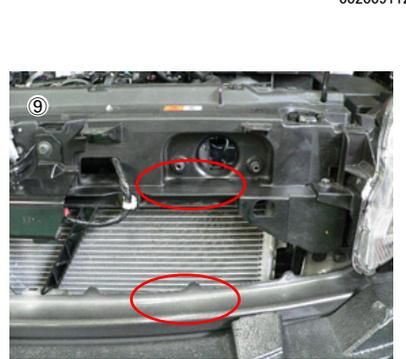
丸印部にアルミ導入プレートを貼り付けます。
