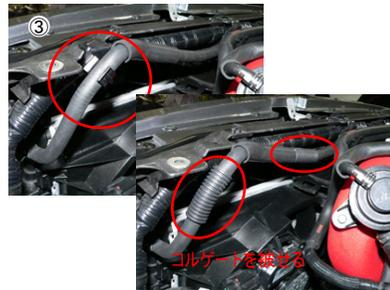
ホースを留めているクリップを外し、写真を参考にコルゲートチューブを被せませます。
