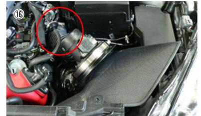
センサーアダプターエアホースに差し込みます。※センサーアダプターとエアホースの吻合は少しきつめとなりますので、ラバーグリスなどを少量塗布して取り付けてください。
