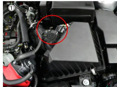
エアフロセンサーのカブラーを外し、エアークリーナーケースを外します。
