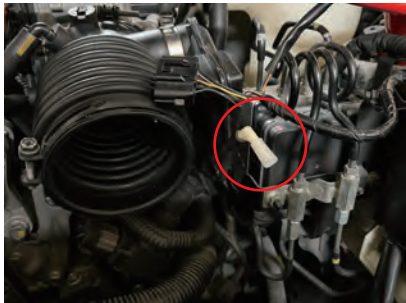
7. バキュームチャンバーを取外した配管に付属のゴムキャップを取付けます。
