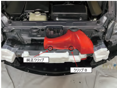
18. フレッシュエアーダクトをクリップ B と純正クリップで固定します。
