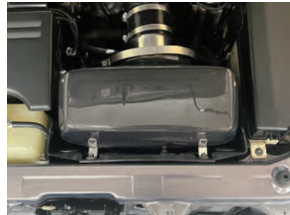
8. アップグレード用エレメントに付替えます。フィルターケースを元に戻します。
