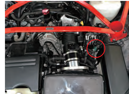
10. エアフロセンサーのコネクターを取付けます。ソレノイドバルブのコネクターを付属のタイラップで固定し、エンジンカバーを取付けます。
