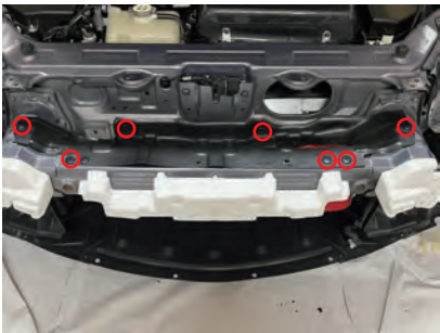
16. 加工した樹脂パネルを純正クリップで車両に取付けます。
