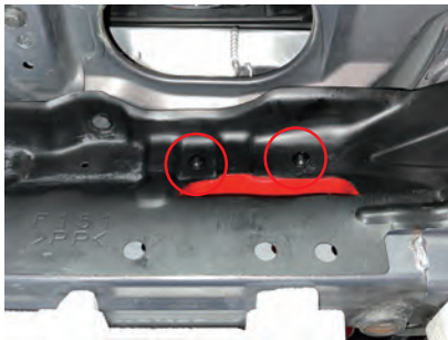
15. 樹脂パネルを車両に載せ、クリップ A x2 でフレッシュエアーダクトを取付けます。
