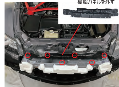
4. 純正クリップ 6 箇所を取外し、樹脂パネルを取外します。
