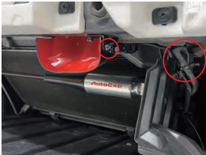
17. フレッシュエアーガイドのステーを増し締めします。外気温度センサーをフレッシュエアーダクトに取付けます。付属のタイラップで配線を固定します。
