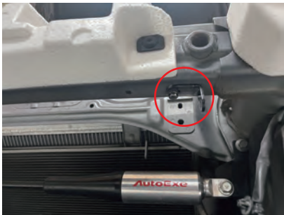
12. ボルト B と M6 ナットでステー A を車両に固定します。
