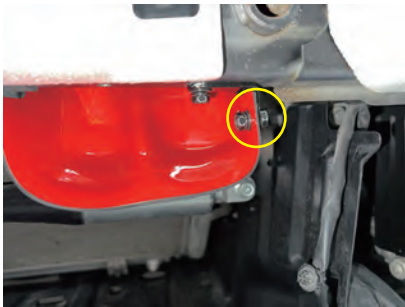
14. ボルト A と M6 ナットでフレッシュエアーガイドを仮止めします。
