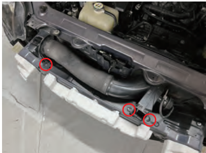
3. 純正クリップ 3 箇所とボルト 1 箇所を取外し、可変フレッシュエアーダクト（VFAD）を取外します。
