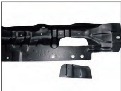
6. 樹脂パネルをカットラインに合わせてカットします。
