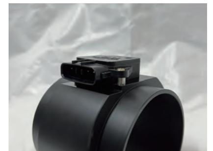
9. エアフローアダプターにM4スペーサーを挟み、ビスDx2でエアフローセンサーを取付けます。
