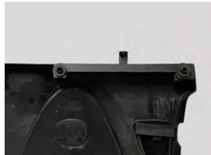
19. エンジンカバーにステー C を取付けます。
