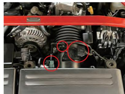
3. エアフローセンサーとソレノイドバルブのコネクターを取外し、配線止めから取外します。
