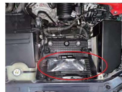
13. ラジエーターカバー上部を洗浄脱脂後、付属の耐熱マットを貼付けます。
