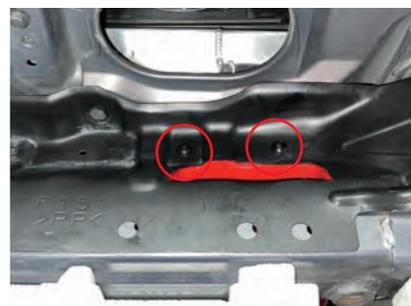
29. 樹脂パネルを車両に載せ、クリップ Ax2 でフレッシュエアガイドを取付けます。
