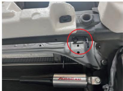
26. ビス B と M6 ナットでステー D を車両に固定します。
