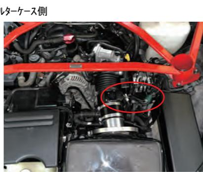
17. エアフローセンサーのコネクターを取付けます。付属のタイラップで配線を固定します。
