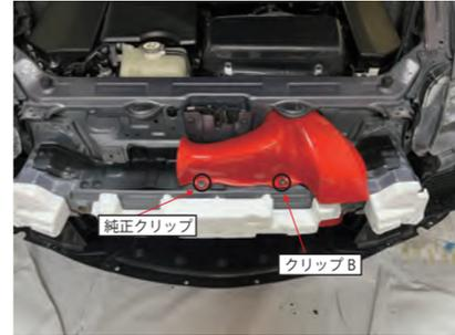
32. フィルターケースを元に戻します。フレッシュエアダクトをクリップ B と純正クリップで固定します。
