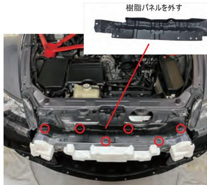
22. 純正クリップ 6 箇所を取外し、樹脂パネルを取外します。
