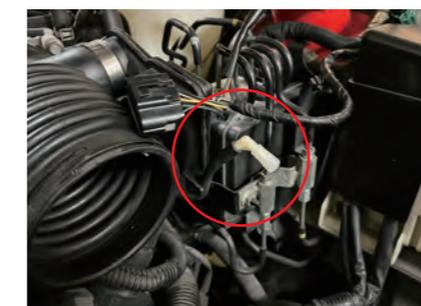
14. バキュームチャンバーを取外した配管にゴムキャップを取付けます。
