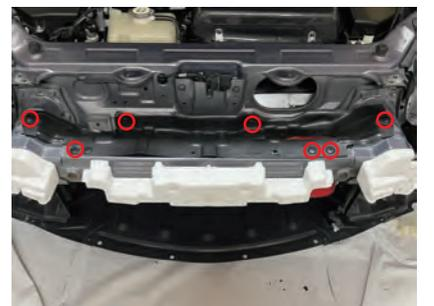
30. 加工した樹脂パネルを純正クリップで車両に取付けます。
