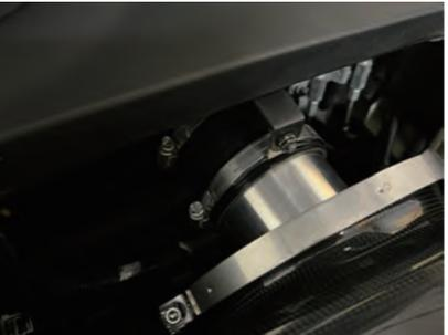
21. エンジンカバーを車両に取付け、位置合わせをして、ビス A と M6 ナットでステーを固定します。ホースバンドを締め付けます。
