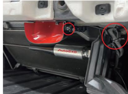
31. フレッシュエアガイドのステーを増し締めし、外気温度センサーをフレッシュエアダクトに取付けます。付属のタイラップで配線を固定します。
