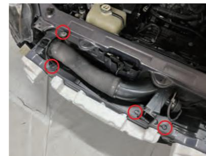
7. 純正クリップ3箇所とボルト1箇所を取外し、可変フレッシュエアダクト(VFAD)を取外します。
