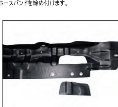
24. 樹脂パネルをカットラインに合わせてカットします。
