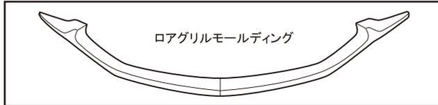
図示の純正ビス8箇所を取外し、ロアグリルモールディングを取外します。
