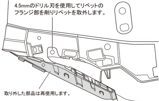
4.5mmのドリル刃を使用してリベットのフランジ部を削りリベットを取外します。
