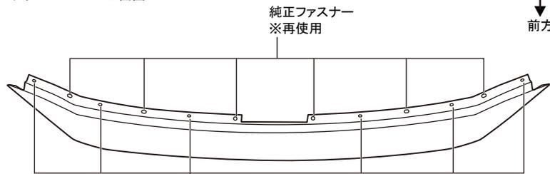
4.5mmのドリル刃を使用してリベットのフランジ部を削りリベットを取外します。
