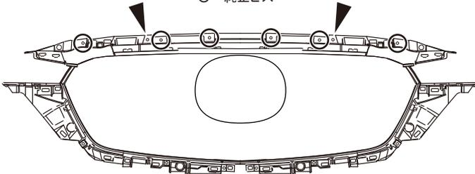
図5 フロントバンパー切除加工
