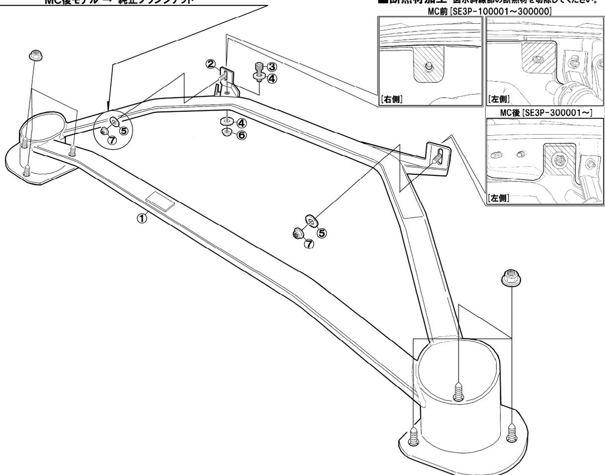
**エンジンカバー加工** ※斜線部及び、マーキング位置を図示を参考に加工してバーの逃げを確保して下さい。
