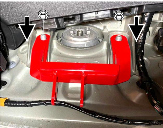
4. ①フロアクロスバーに仮組してある、③フロアクロスバーブラケット LHを取り外します。
