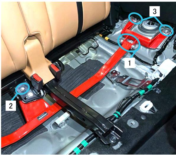
7. 5. 6. で仮固定した車両ナット、⑨フランジナット、⑦袋ナットを下記の順で本締めします。
