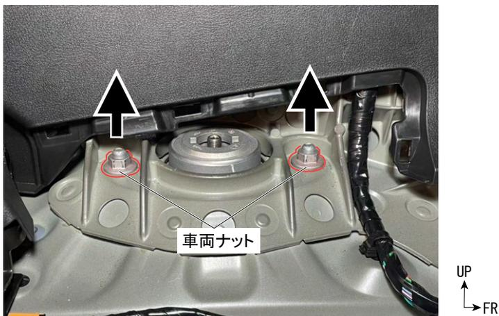
3. リアアップーマウントを固定している車両ナット(左右各2ヶ所)を取り外します。
