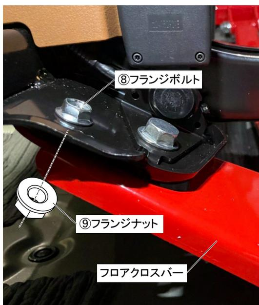
A. シートフレームに⑧フランジボルト と⑨フランジナットを用いて、①フロアクロスバーを仮固定します。
