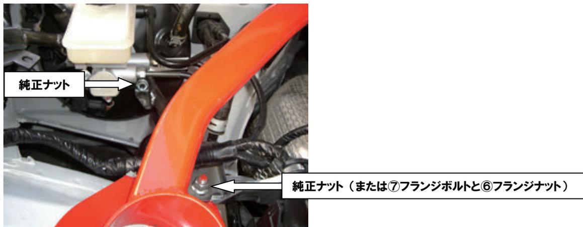
5. マスターシリンダーを固定しているナットを取外し、純正ナットと⑦フランジボルトを使用して①アウターサポート(RH)を取付けます。
