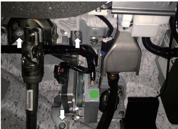
2. ブレーキペダルユニットを固定しているボルトとナットを取外し、④インナーサポート(RH)、⑤インナーサポート(LH)を、純正ボルト、ナットで固定します。
