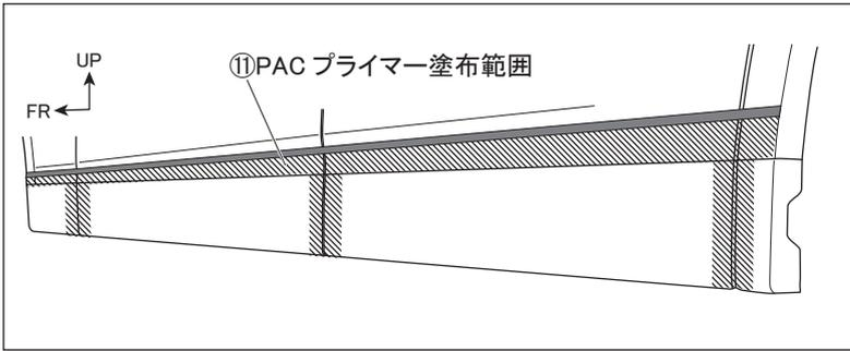
10. 車両側面の左図斜線部を洗浄脱脂し、⑪PAC プライマーを塗布します。
