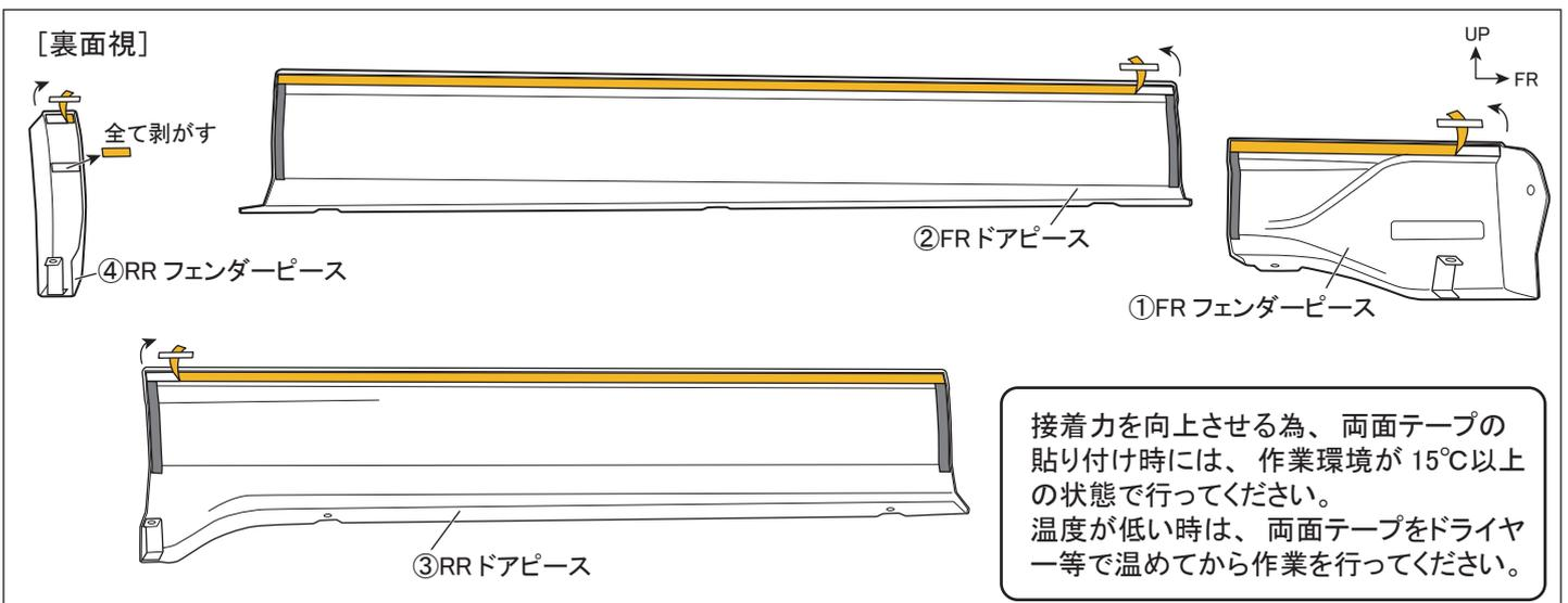
14. ①FR フェンダーピースのモール上端をマスキングテープ下端に合わせて車両に仮当てし、ホイールハウス折り返し部を⑥ファスナーで取り付け（左右各 1ヶ所）、下面を⑤トラスボルトと⑦フランジナットで仮締めします。（左右各 2ヶ所）
