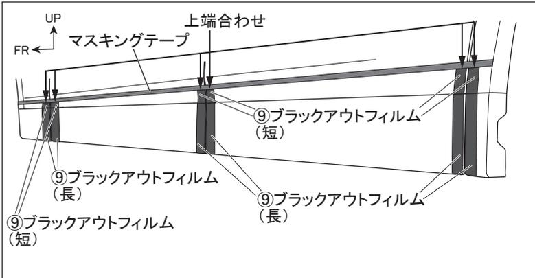
11. 車両側面のマスキングテープに合わせて左図位置に⑨ブラックアウトフィルムを切れ目でカットして貼り付けます。(左右各12ヶ所)
