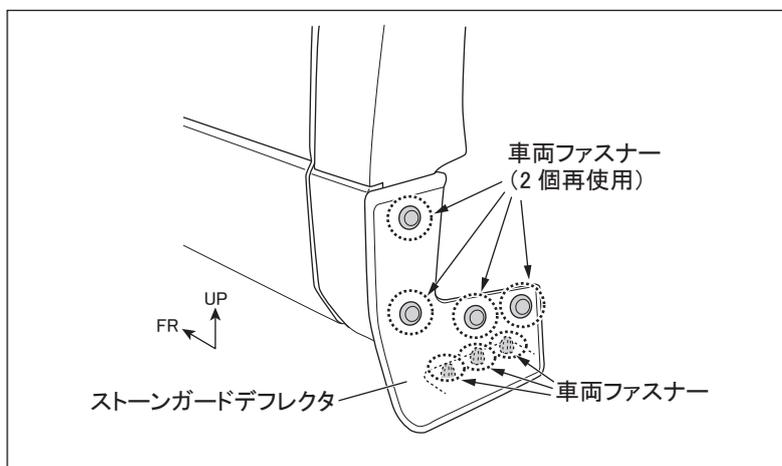
2. サイドシル後方のストーンガードデフレクタを取り外します。（左右各 1ヶ所）
