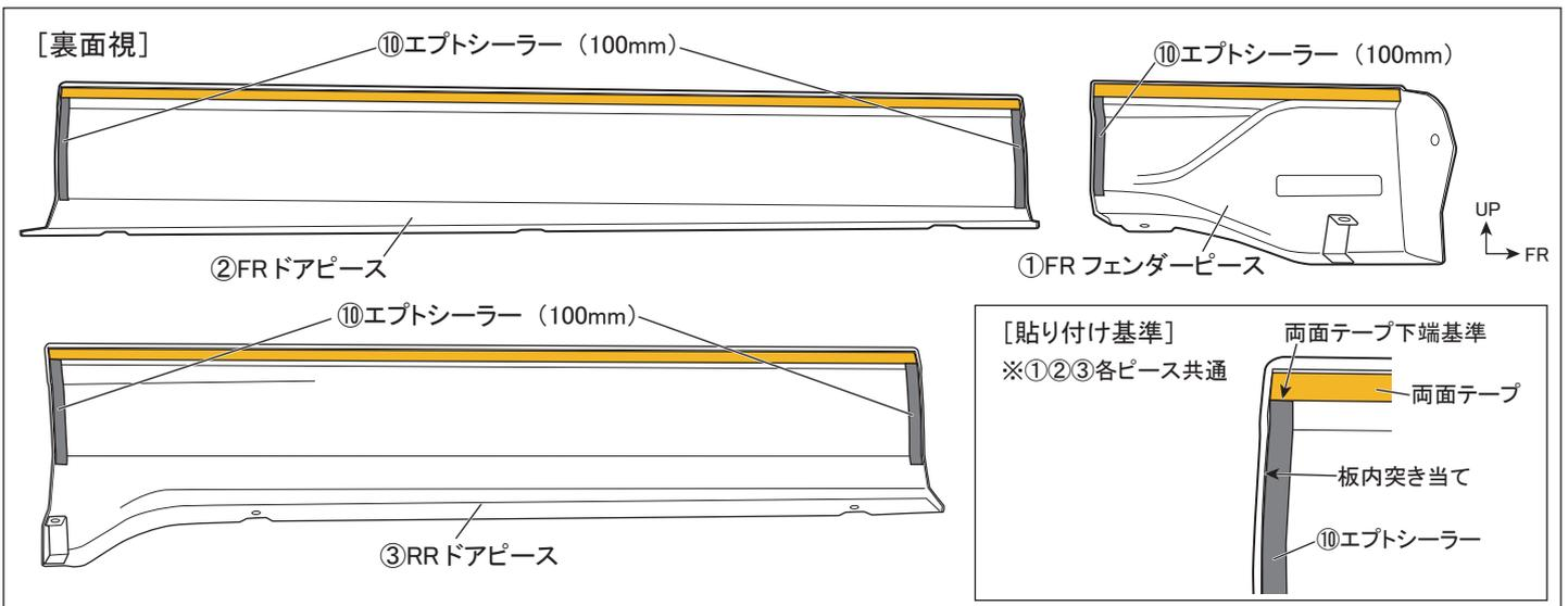
13. ①②③④各ピース裏側の両面テープ離型紙を30mm程度剥がし、表側へ折り返してマスキングテープで固定します。
