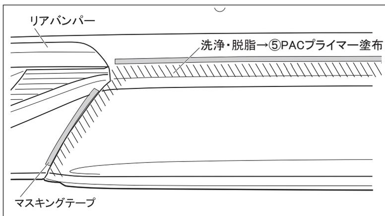
5. リアバンパーの両面テープ貼り付け部（左図斜線部）を洗浄脱脂し、⑤PACプライマー N-200 を塗布します。
