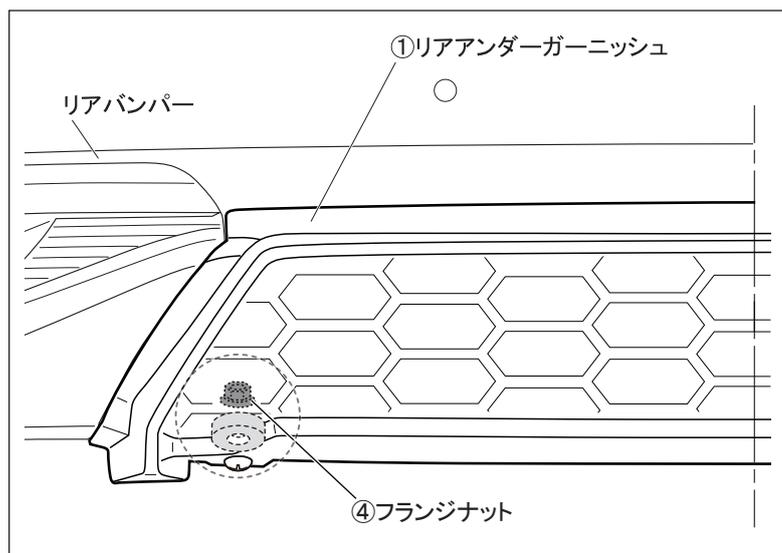
9. 7.で仮締めした②トラスボルトと、③ゴムワッシャー、④フランジナットを本締めします。
