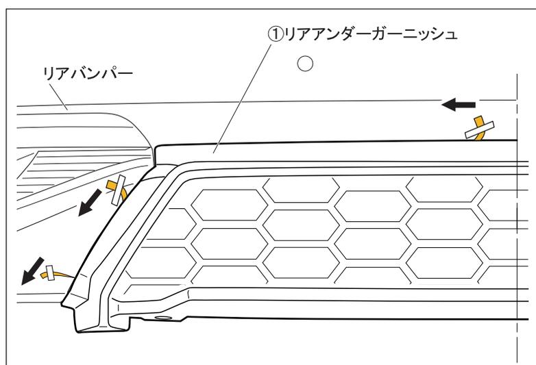
8. ①リアアンダーガーニッシュの両面テープ離型紙を中央から外側へ引き抜きながら貼り付け面を十分に圧着します。
