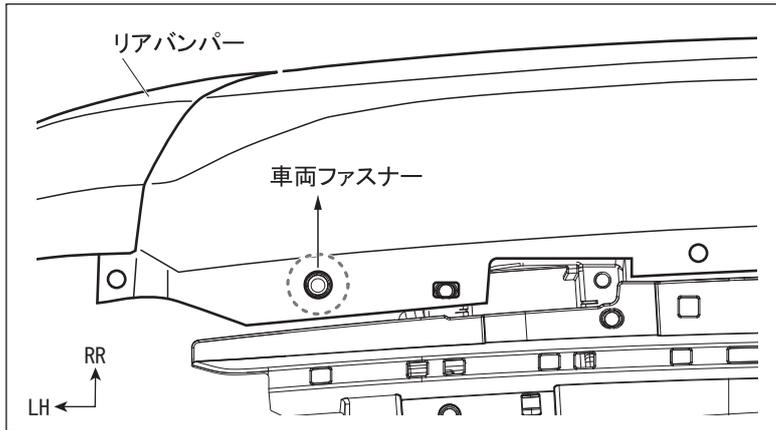
1. リアバンパー下面の車両ファスナーを取り外します。（左右各1ヶ所）
