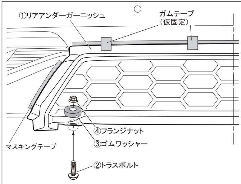
2. ①リアアンダーガーニッシュを車両に仮あてし、1.で取り外した位置に ②トラスボルトと③ゴムワッシャー、④フランジナットを用いて位置を決め、ガムテープ等で固定します。
