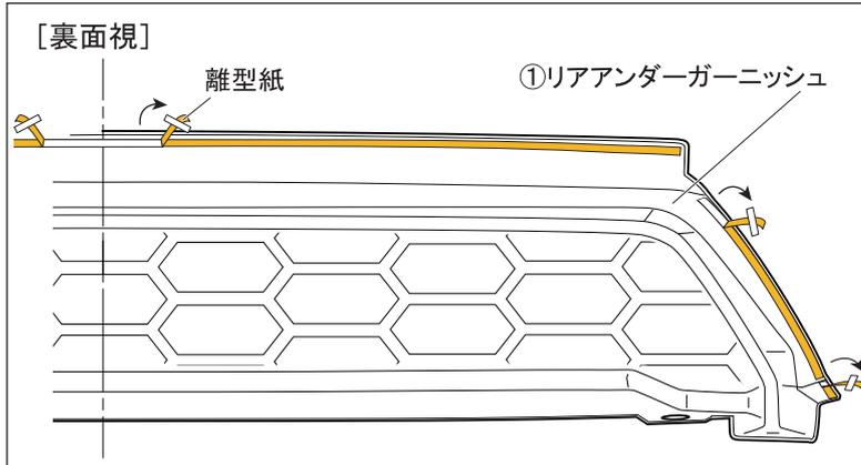
6. ①リアアンダーガーニッシュ裏側の両面テープ離型紙（上部）は中央に切れ目を入れて中央側から30mm程度、（端部）は上側から30mm程度、をそれぞれ剥がし、表側へ折り返してマスキングテープで固定します。
