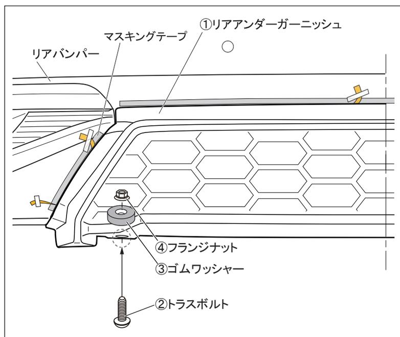
7. ①リアアンダーガーニッシュを車両に仮あてし、1.で取り外した車両ファスナーの締結個所(左右各1ヶ所)を②トラスボルトと③ゴムワッシャー、④フランジナットで仮締めします。
