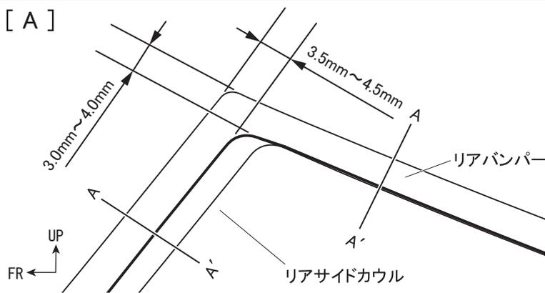
A. リアサイドカウルとリアバンパーの2辺、各端部の距離が指示寸法に収まるよう位置を調整します。
