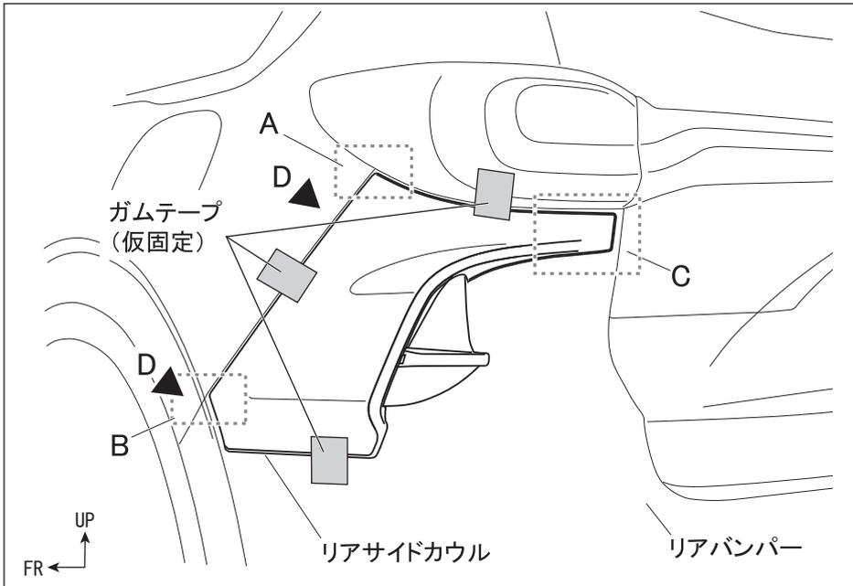
1. リアバンパーにリアサイドカウルを仮あてし、ガムテープ等で仮固定します。この際、コーナーA→B→Cの順で、リアサイドカウルとリアバンパーの端部の距離を指示寸法に収めるよう調整しながら位置を決めます。
