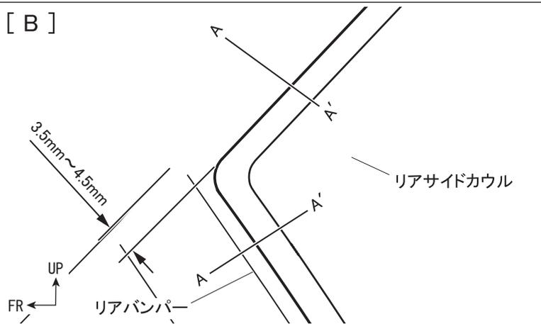
B. A.同様、端部の距離が指示寸法に調整します。
