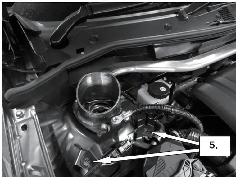
6. バッテリ(－)ケーブルとバーが接触する場合は、(－)ケーブルを手で曲げてバーとの適切なクリアランスを確保して、作業完了です。
