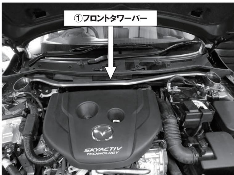
5. 2. で取外したボルト2本を取付けます。
