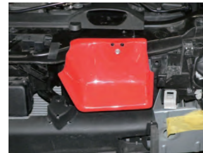
8.ホーンが固定されていた場所に純正ボルトでフレッシュエアークガイド（ロア）を固定します。
