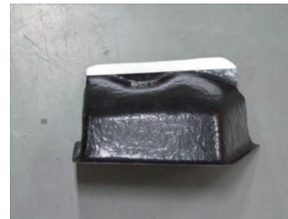
7.フレッシュエアークガイド（ロア）の図示部に両面テープを貼付し、剥離紙を剥がしておきます。
