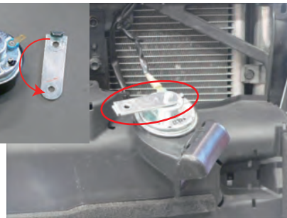
3.ホーン（LH）から取付けステーを一旦外し、表裏反転して取付けます。
