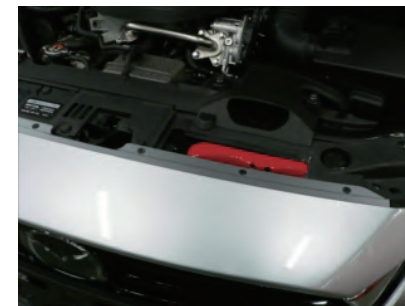
11.フロントバンパーを車両に復元し、切除加工したシールボードアッパーを車両に復元します。
