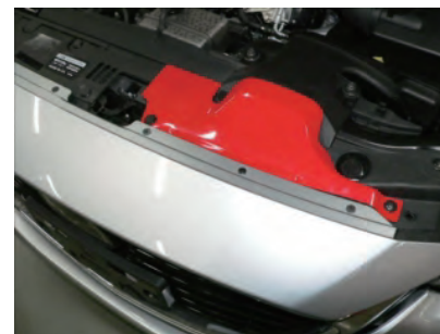
13.純正ファスナーとボルトを使用して、フレッシュエアークダクト（アッパー）を車両に固定します。
