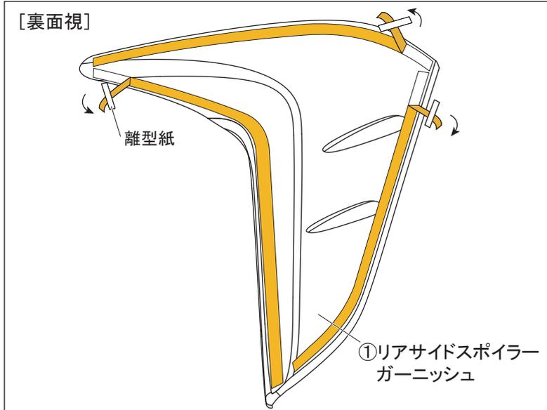
5. ①リアサイドスポイラーガーニッシュ裏側の両面テープ離型紙を30mm程度剥がし、表側へ折り返してマスキングテープで固定します。（左右各3ヶ所）
