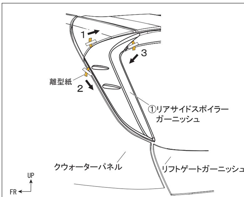
6. 手順1.と同様に①リアサイドスポイラーガーニッシュの位置を合わせ、決めた位置がずれないように両面テープ離型紙を左図矢印の方向と順番で引き抜きながら貼り付け面を十分に圧着します。
