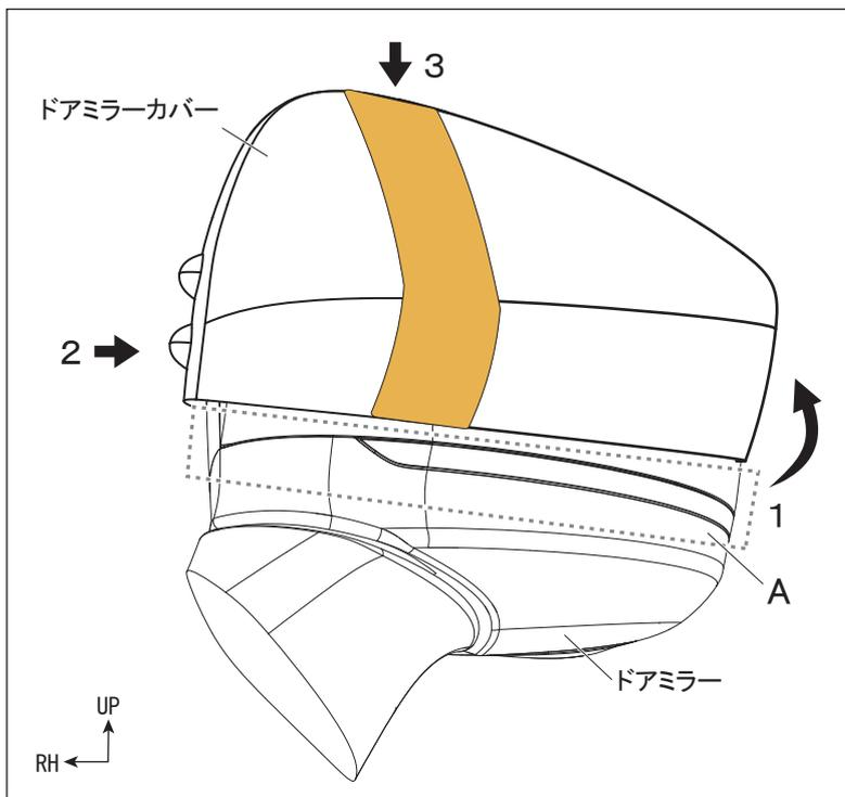
6. 車両ドアミラーにドアミラーカバーを仮あてします。この際、左図のようにドアミラーカバー下端から車両ドアミラーに被せながら、A部を下図の通り、車両ドアミラーの塗装部の端部に合わせ、塗装部が隠れるよう調整しながら、位置を決めます。
