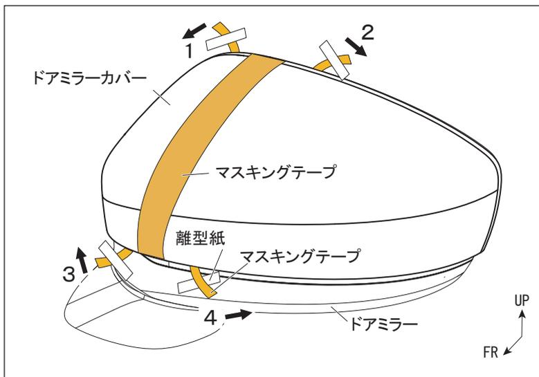
7. 6.で合わせた位置がずれなく、分割部の隙が広がらないよう手で押さえつつ、両面テープ離型紙を左図矢印の方向と順番で引き抜きながら貼り付け面を十分に圧着します。
