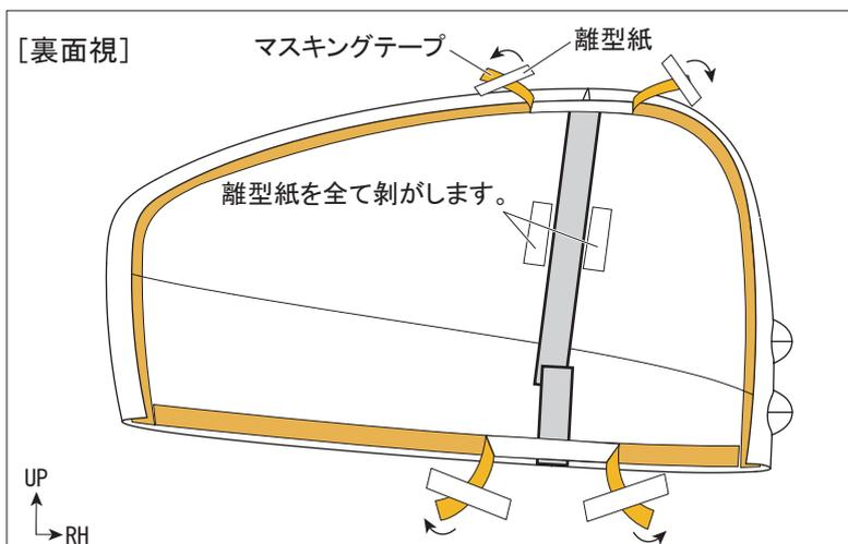
1. ドアミラーカバー を車両ドアミラーに仮あてします。
