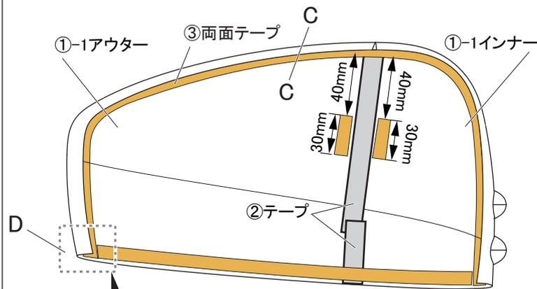
4. 2. で組み立てた①-1アウター、と①-2インナーの裏面に③両面テープを貼り付け、圧着します。この際、③両面テープ貼付け部を洗浄脱脂し、⑤PACプライマーN-200を塗布します。
