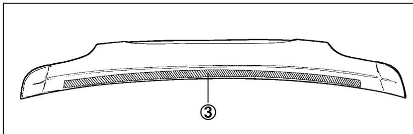
※外気温度が15℃以下の場合、両面テープの接着力が低下しますので、テープおよび取付面をドライヤー等で約40℃前後に加温してから取付けてください。
