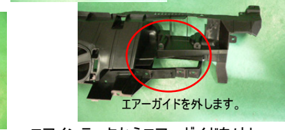
⑧ ※純正バンパー車のみ作業 クリップを外します。 エアインテークからエアガイドを外し、エアガイドをバンパーに復元します。
