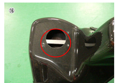
⑯ アダプターとカーボンダクトケースの間に整流フィンを配置します。
