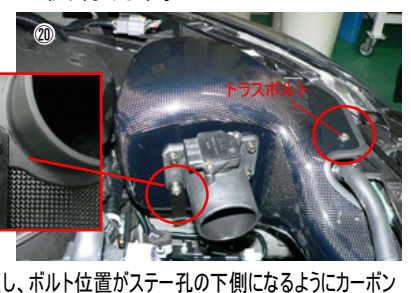
⑳ 写真を参照し、ボルト位置がステー孔の下側になるようにカーボンダクトケースを上から押さえながら、ステーを取り付けます。同時にカーボンダクトケース上部をトラスボルトで固定します。
