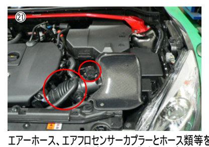
㉑ エアホース、エアフローセンサーカバーとホース類等を元に戻し、ステーを本締めして作業完了です。その際、センサーアダプターとエアホースの勘合は緩めですが、そのまま純正ホースクランプで締めてください。
