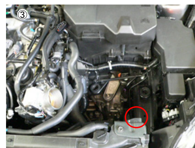
③ ボルトを外し、エアホースごとクリーナーケースを取り外します。
