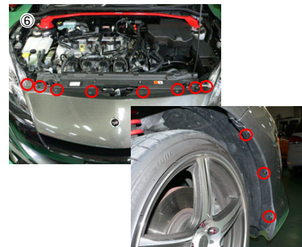
⑥ バンパー上側のクリップ、ボルトを外します。インナーフェンダーのクリップを外します。
