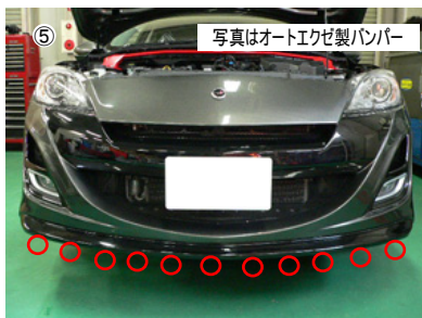
⑤ 写真はオートエクス製バンパー 導入プレートを取り付ける為、バンパーを外します。下側のタッピング、ボルトを外します。(純正バンパー車も同様に取り外してください。)
