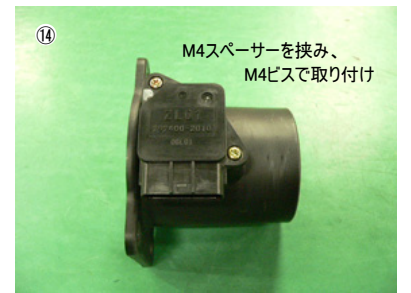
⑭ ノーマルケースから取り外したエアフローセンサーをセンサーアダプターに取り付けます。
