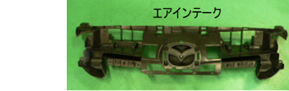
⑦ ※純正バンパー車のみ作業 エアインテーク 純正バンパー裏のエアインテークを取り外します。
