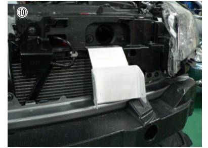
⑩ 脱脂して、両面テープで貼り付けます。
