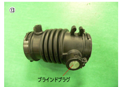
⑬ エアホースの残り穴に、純正ホースクランプを使用してブラインドプラグを取り付けます。
