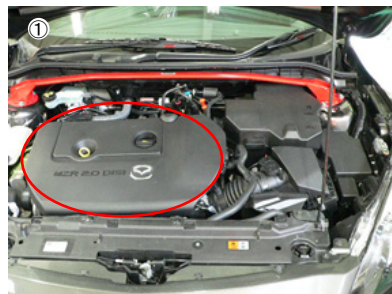
① エンジンカバーを外します。
