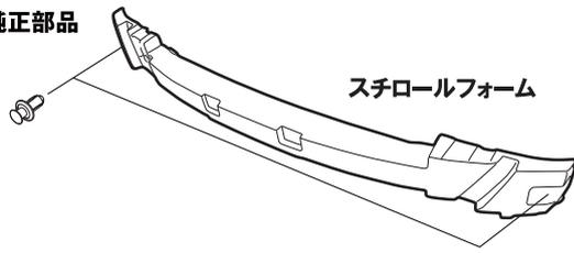
バンパースティフナー左右下部の斜線部をカッター等でカットしてください。(左右同作業)
