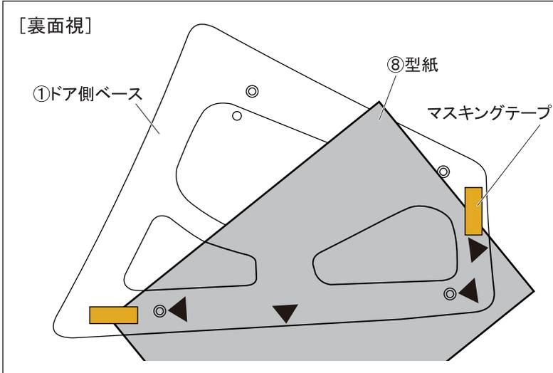
2. ①ドア側ベース裏面に⑧型紙を左図のように貼り付けます。
