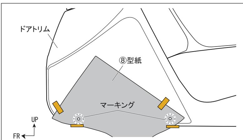
6. ドアトリムに①ドア側ベース取り付け用穴開け位置をマーキングします。
