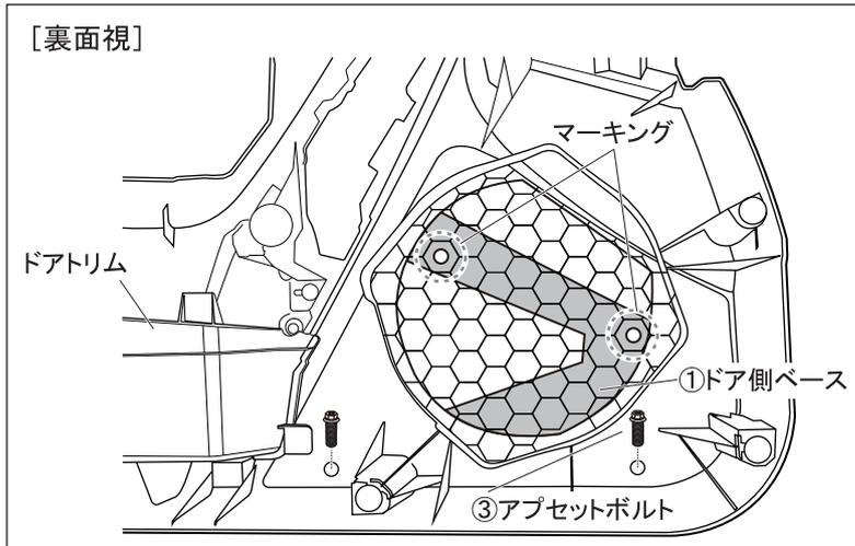
9. ③アプセットボルトを使用し、①ドア側ベース下側2ヶ所を仮止めします。
