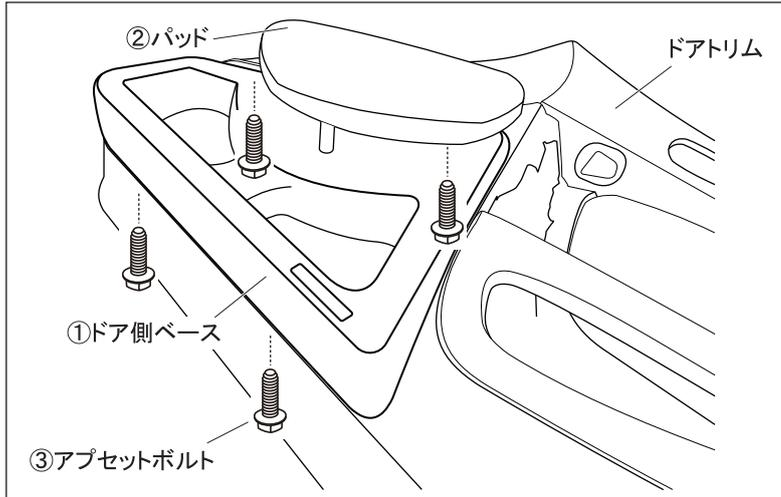
15. ③アプセットボルトを使用し、①ドア側ベースをドアトリムに固定します。
