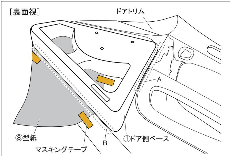
3. ①ドア側ベースを1. で取り外したドアトリムに仮あてします。その際、矢印A部はドアトリムR止まりに合わせ、矢印B部はドアトリムR止まりに合わせつつ合い沿いが合う(ズレ無く重なる)位置に調整します。
