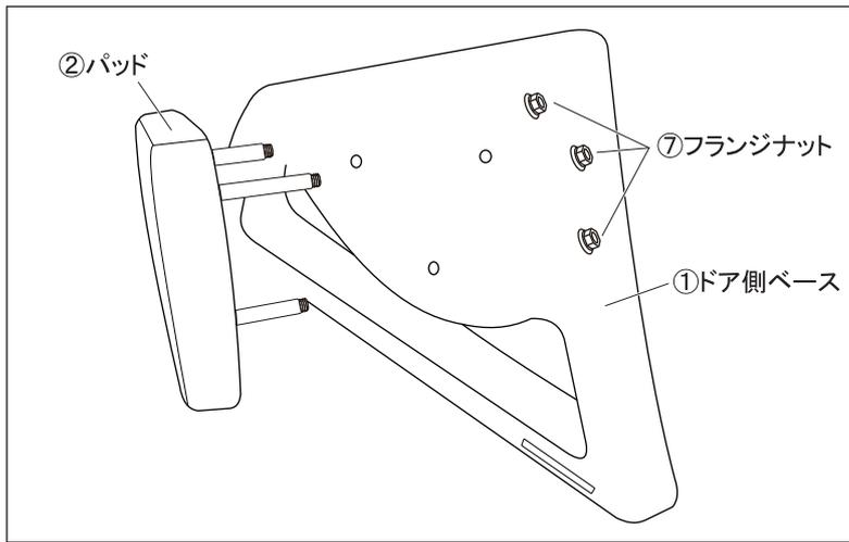
14. 13. で組付けた②パッドと①ドア側ベースを⑦フランジナットを使用して組み立てます。
