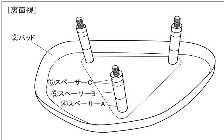
13. ②パッドに④スペーサー-A、⑤スペーサー-Bを取り付け好みの高さになるよう高さ調整用⑥スペーサー-Cの取り付けを選択します。
